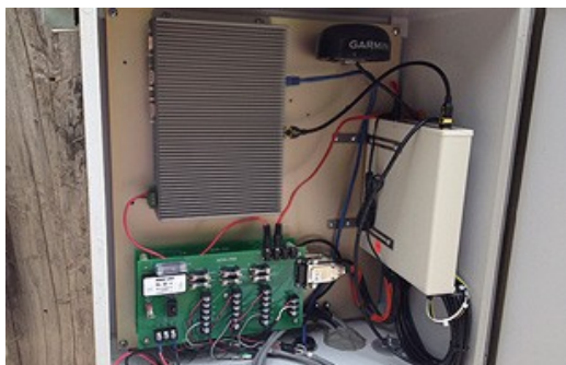
Il sensore per alberi dell'HMI Apparecchiatura di acquisizione dati ad alta risoluzione utilizzata per il monitoraggio degli alberi.
